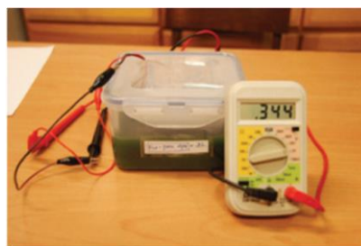
圖 15. 使用保鮮盒、碳布、質子交換膜、銅線及藻類等組裝成的藻類電池。
