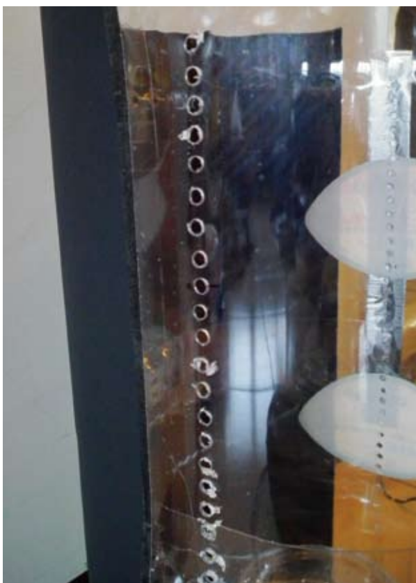
圖3 罐身側面打出一排進氣孔
