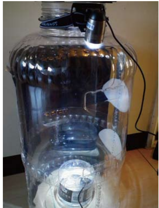
圖8 LED燈由上而下照射可更清楚看到煙霧
