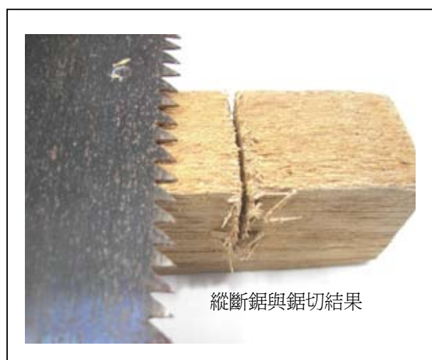
圖3 嘗試錯誤：縱斷鋸與橫斷鋸的鋸齒與鋸溝
