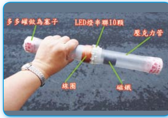
圖 7：將壓克力管內的磁鐵，上下翻動，經過線圈時 10 顆燈都亮。
