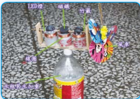
圖 6：風力發電機的組合方法
