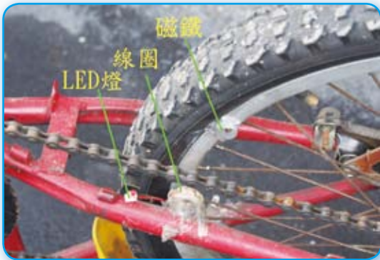
圖 2：組合方式示意，線圈裝置位置以轉動時不碰掉磁鐵為原則，二者盡量接近。
