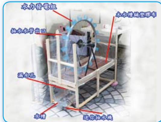
圖 5：水力發電套件，水沖擊水車後積於塑膠布，再由漏水孔流到下方水槽，利用抽水馬達將水抽回上方，繼續沖擊水車。
