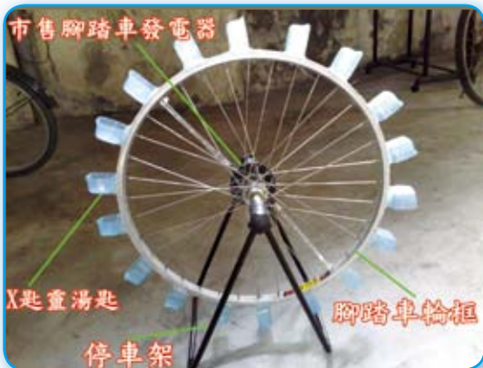
圖 4：水力發電，用水沖 X 匙靈湯匙，使水車轉動，燈就會亮。
