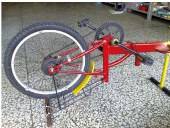
圖 1：腳踏車發電全貌，轉動踏板，燈亮就過關。
