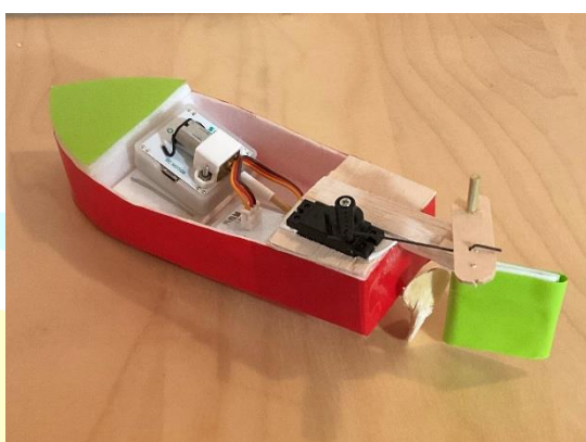
圖 11.藍芽控制 SamLabs 馬達驅動螺旋槳及船舵
