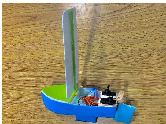
圖 19. 帆船尾端兩具 SamLabs Space 黑色伺服器
