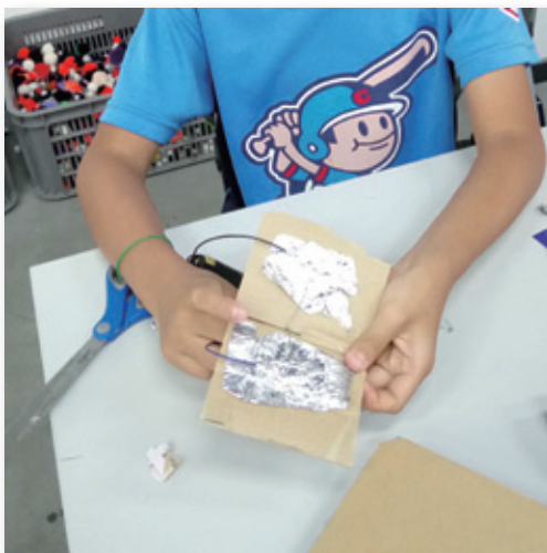
圖 7. 電線與鋁箔相接，並貼在紙板上，就成為可以開關的開關
