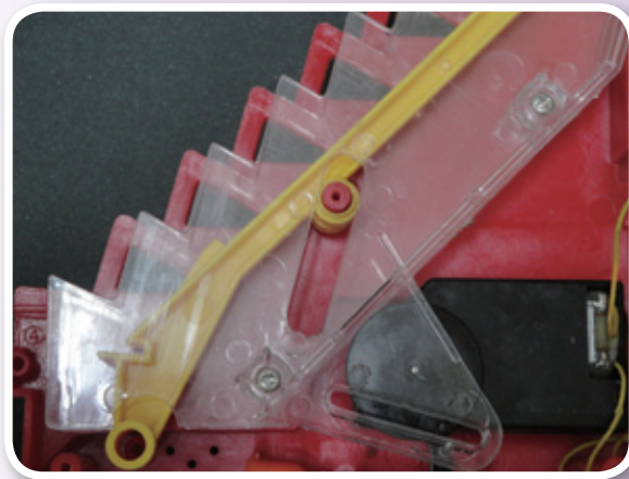
圖4. 平板上有另一個限動的滑軌設計，讓其僅止於上下移動，協助車偶垂直向上，而不是在階梯上平移
