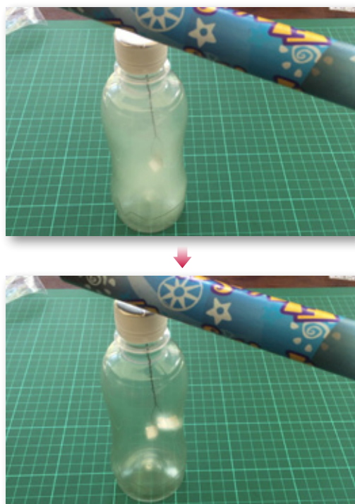
圖 6. 除塵實驗結果
