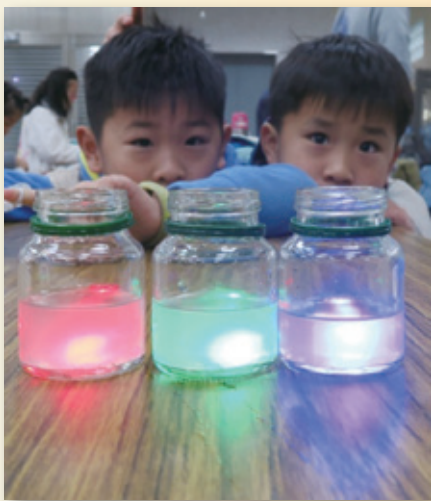
圖 14. 各種色光在牛奶中的散射角度不同。使白光穿過牛奶時偏黃色，像陽光一樣
