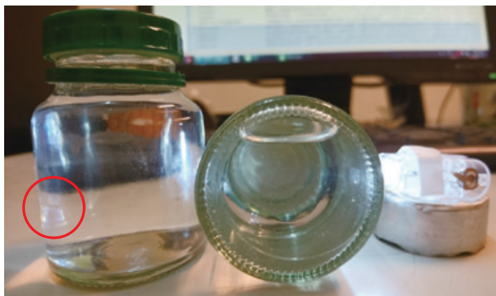
圖 12. 用兩支雞精瓶（裝滿水）與白光，可以模擬彩虹的生成原理
