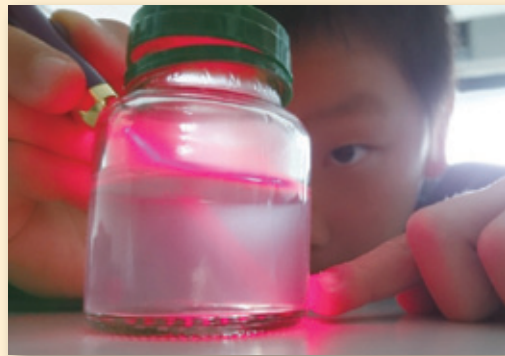
圖 13. 在水中加牛奶並在瓶中施放煙霧，觀察折射的現象超清楚
