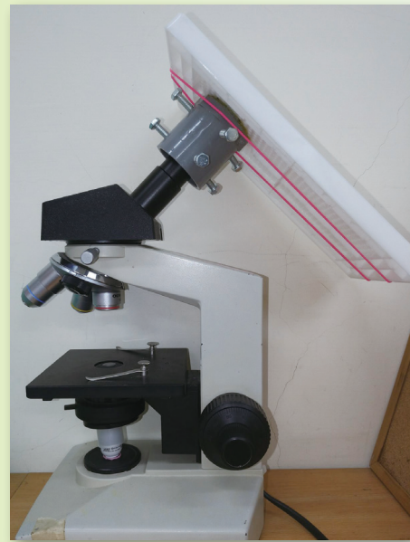
圖 9. 手機架安裝完成圖
