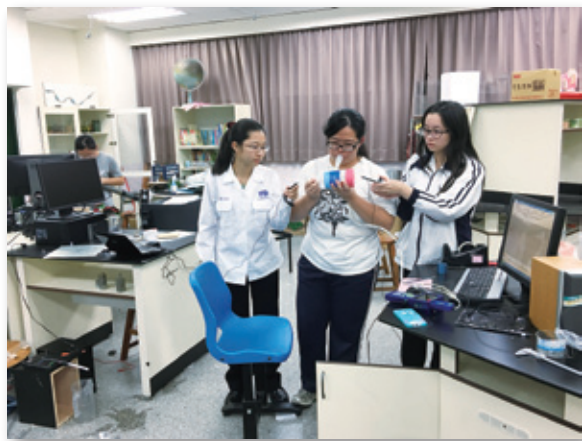
圖 3. 學生利用數位量測儀器 GLX 測量氣流量
