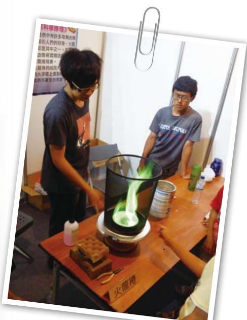
圖 4：「一柱擎天火龍捲」透過簡易實驗說明火龍捲的現象與成因，觀察高熱火源碰上擾動的空氣亂流所產生的現象。
