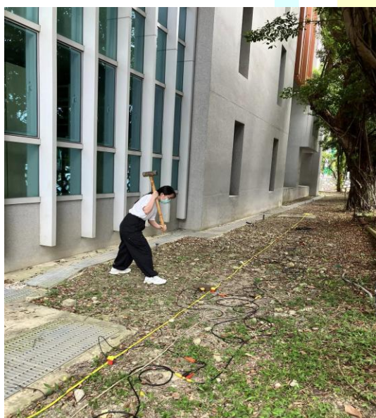
圖 5 學生舉起大鐵鎚由肩膀高度向下敲擊鐵板，產生人工地震波
